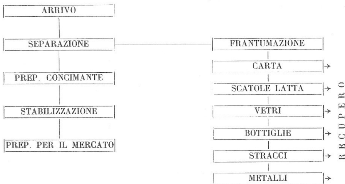
Fig. 27. - Operazioni di trattamento dei rifiuti greggi secondo Stovroff.
