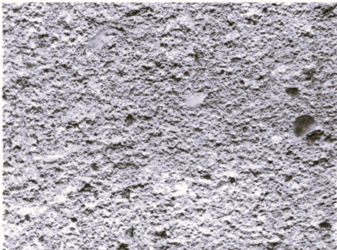
Fot. 3. - Blocco n. 3: Impasto di cemento e sabbia (Libano).
