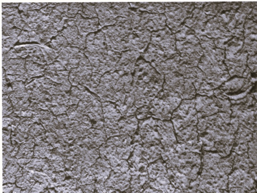
Fot. 2. - Blocco n. 2: Impasto di \frac{2}{3} di fango scuro e \frac{1}{3} di paglia fine (Libano).
