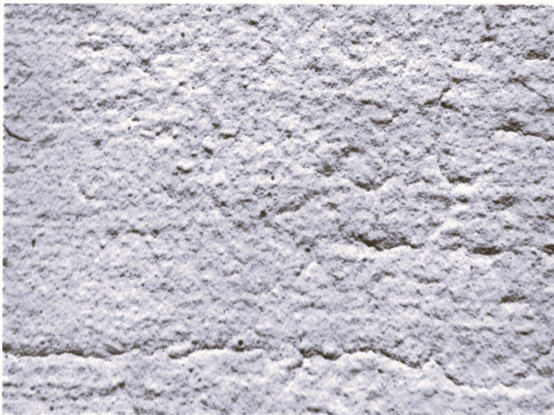
Fot. 1. - Blocco n. 1: Impasto di \frac{2}{3} di fango chiaro e \frac{1}{3} di paglia fine (Libano).
