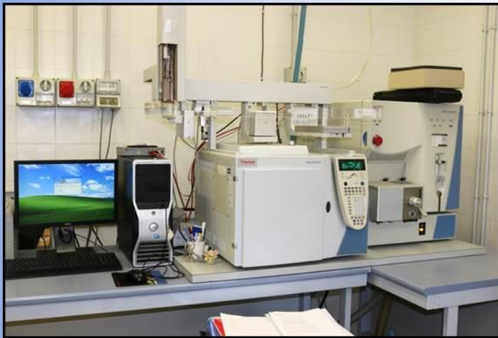
Gas cromatografo accoppiato a rivelatore di spettrometria di massa a triplo quadrupolo
