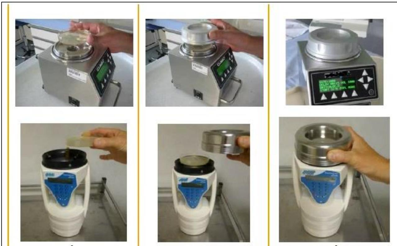
Figura 2 Strumenti per il monitoraggio della contaminazione microbica aerodispersa; Fonte: “Surveillance microbiologique de l’environnement dans les ES – CCLIN Sud-Ouest – 2016”.
