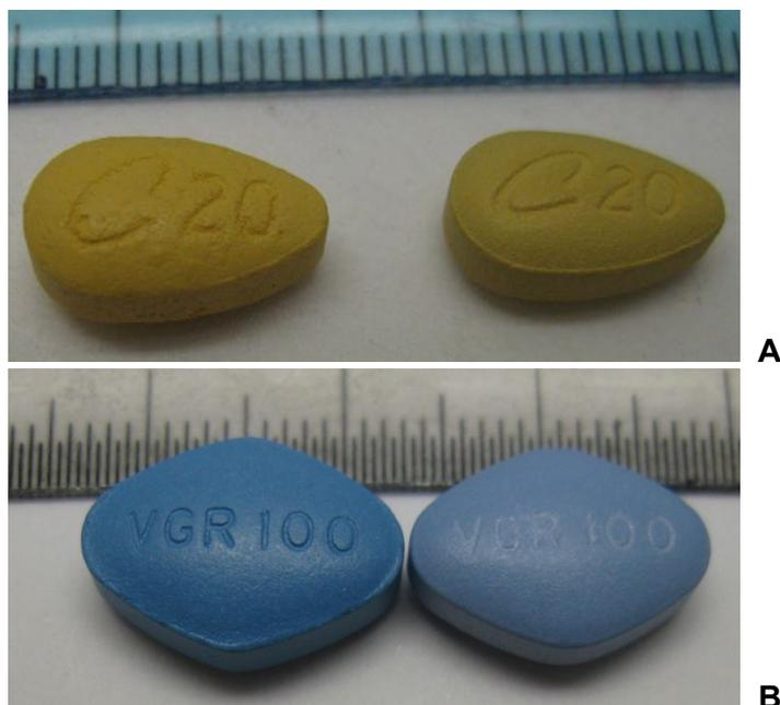
**Figura 8. Esempi con ingrandimento digitale di compresse falsificate (sinistra) a confronto con gli originali (destra). Si notino le differenze nel colore delle compresse, nella rugosità della superficie e nell'incisione "C 20" (A) e "VGR 100" (B)**
