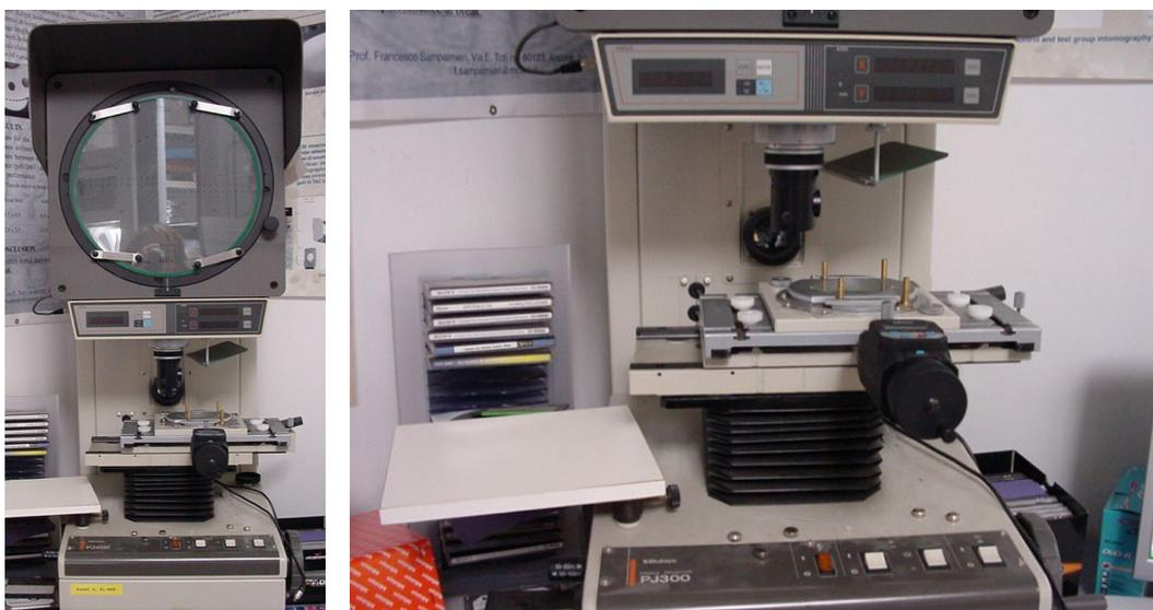
**Figura 16. Apparecchiatura Proiettore di Profili Modello PJ 300 (MITUTOYO) utilizzata per la prova di diametro delle lenti a contatto**
