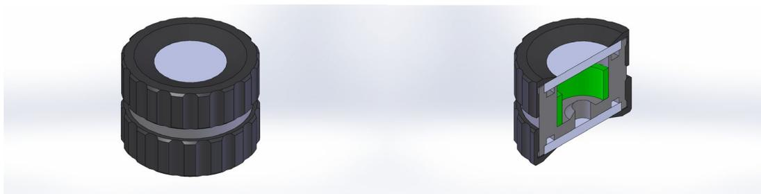
**Figura 22. Disegno tecnico tridimensionale del supporto per lenti a contatto utilizzato per il corretto posizionamento della lente**
