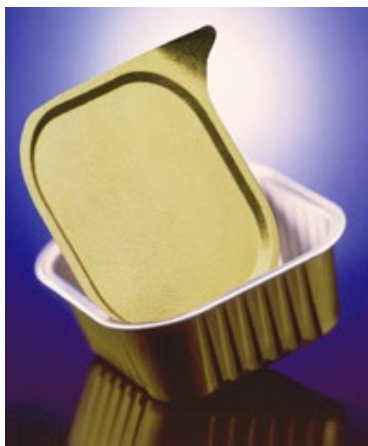
Figura B7.11.d. Tipico contenitore realizzato con alluminio accoppiato internamente a film di CPP verniciato esternamente, coperchio termosaldabile verniciato esternamente e rivestito per costruzione con PP
