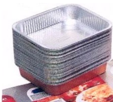
Figura 7.11.c. Contenitori di tipologia smooth wall verniciati con rivestimenti resistenti alla cottura in forno tradizionale (chiusura tramite film multistrato termosaldato sul bordo del contenitore); adatto a conservare prodotti surgelati e non
