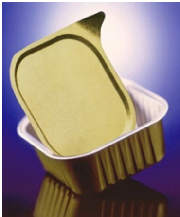
Figura B7.11.d. Tipico contenitore realizzato con alluminio accoppiato internamente a film di CPP verniciato esternamente, coperchio termosaldabile verniciato esternamente e rivestito per coestrusione con PP
