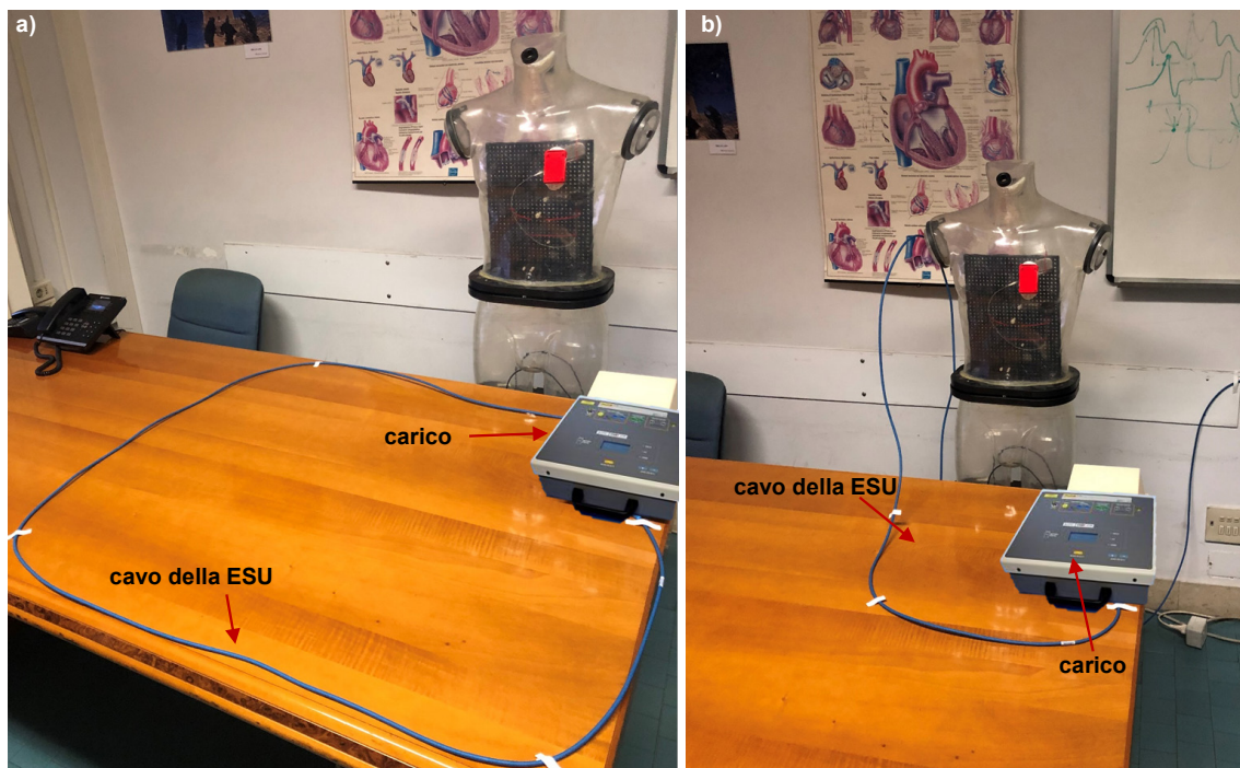
Figura 4. Set-up sperimentale adottato per i test sulla ESU, il cavo della ESU è disposto in modo da massimizzare: il campo magnetico risultante (a) e il campo elettrico risultante (b)
