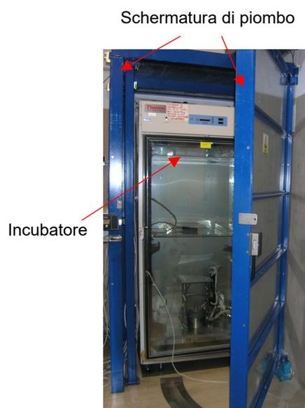
**Figura A5. Gabbia schermante di piombo e incubatore al suo interno**
