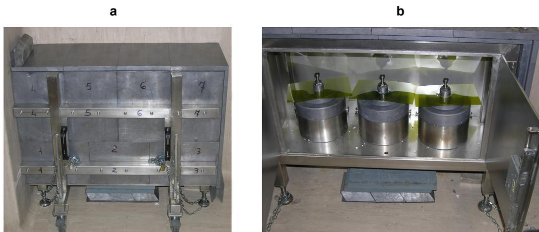
**Figura A2. Cassaforte di piombo (a) e cilindri di piombo contenenti le sorgenti di Cs-137 (b) all'interno della cassaforte di piombo**
