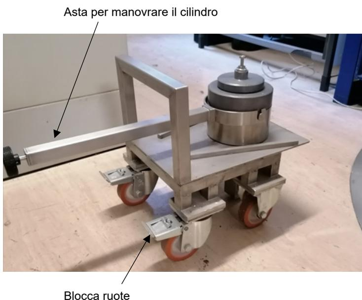
**Figura A3. Carrello per spostare il cilindro contenente la sorgente in incubatore**
