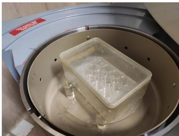
**Figura 2.8. Modalità di irradiazione di capsule Petri all'irradiatore al Cs-137 presente in ISS**
