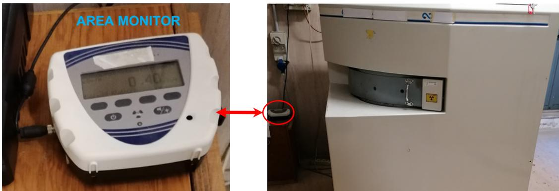
**Figura 2.3. Foto dell'area monitor utilizzata come sistema di allarme nella stanza dove è presente l'irradiatore ISS**
