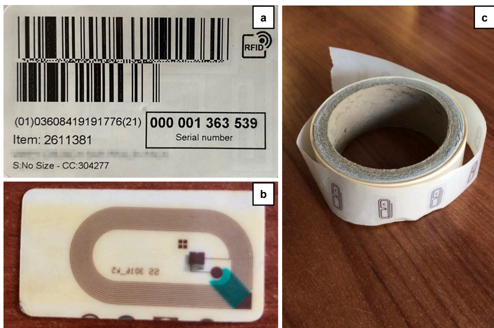
Figura 10. Etichetta stampabile con tag RFID a) fronte etichetta stampata; b) retro etichetta con tag RFID; c) etichette RFID per stampa automatica
