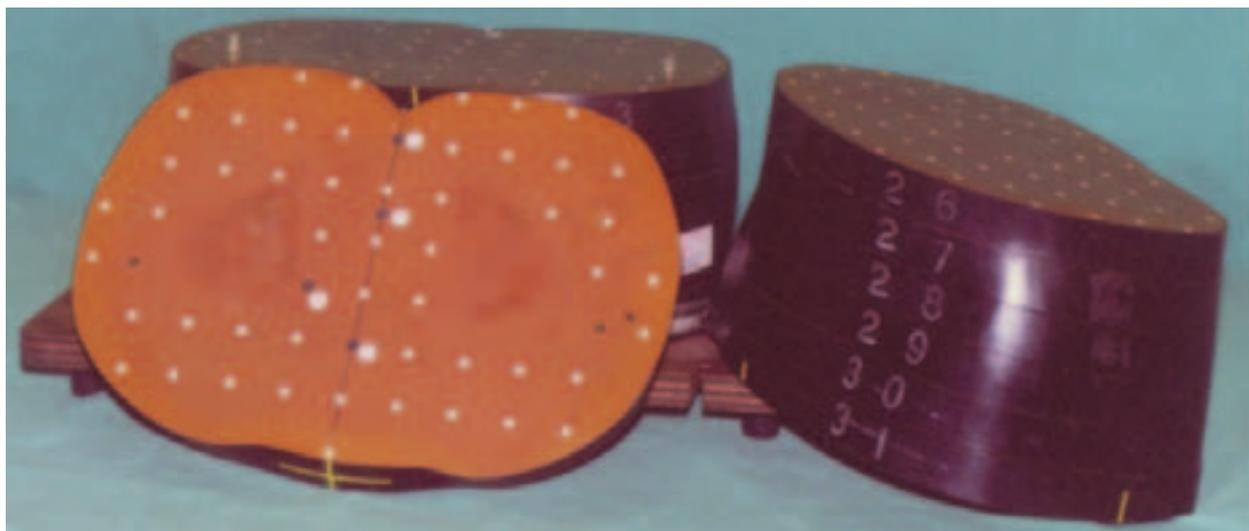
**Figura 4** - Sezione centrale del fantoccio antropomorfo che contiene il centro del volume di trattamento. I pallini bianchi di dimensioni maggiori indicano gli alloggiamenti per i dosimetri
