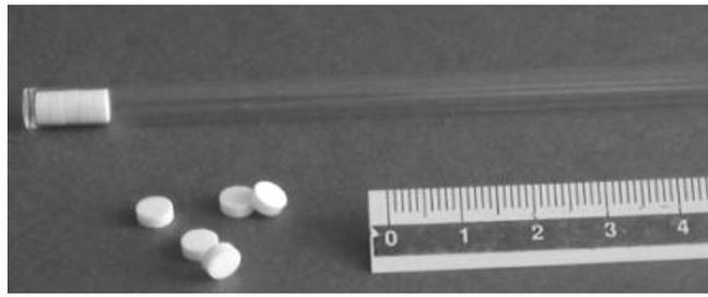
Figura 8. Dosimetri ad alanina realizzati presso l'ISS
