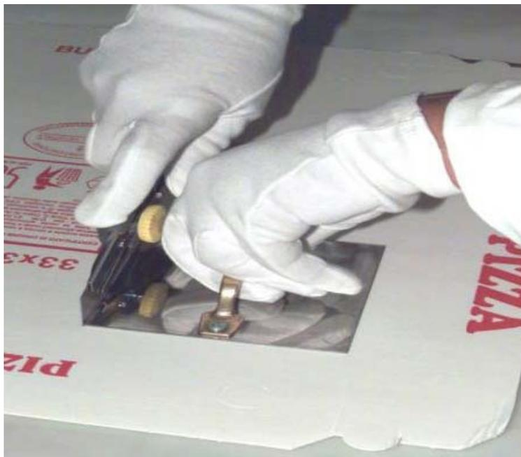
Figura 1. Particolare del taglio del provino
