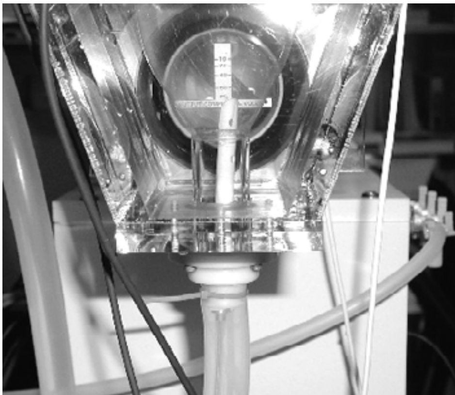
Figura 5. Visione frontale del montaggio transapicale della cannula del dispositivo di assistenza ventricolare
