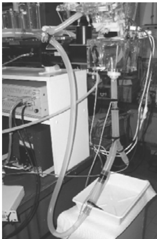
Figura 4. Visione della parte anteriore del banco di prova dove si evidenzia il montaggio per permettere al dispositivo di avere una posizione transapicale. Si noti la Y connessa al tubo di scarico ( drain ) per consentire la fuoriuscita del drive cable della pompa
