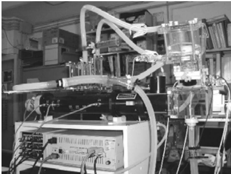
Figura 3. Visione laterale di una parte del banco di prova, dove si evidenzia il raccordo ad Y tra il tubo proveniente dall'aorta e il tubo proveniente dall'HP 31 in posizione transapicale
