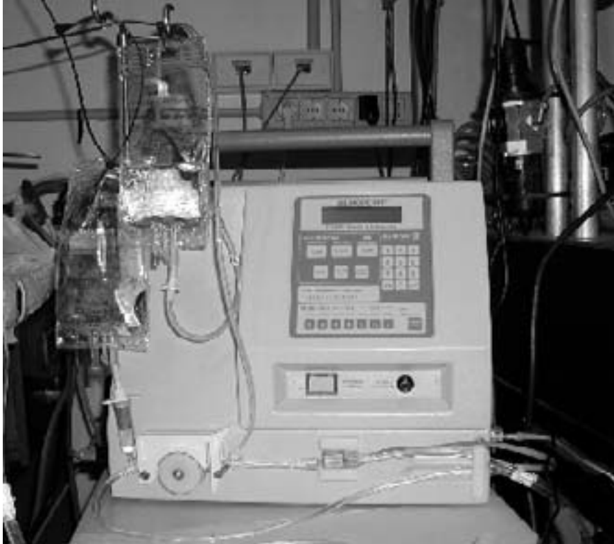
Figura 2. Console del dispositivo con le sacche di destrosio del circuito di lubrificazione
