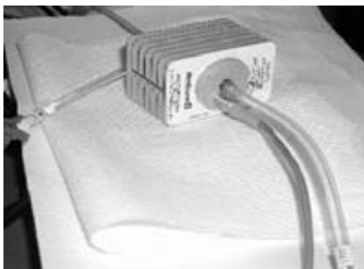
Figura 1. Motore magnetico del dispositivo (si nota il drive cable in uscita e il circuito di lubrificazione)
