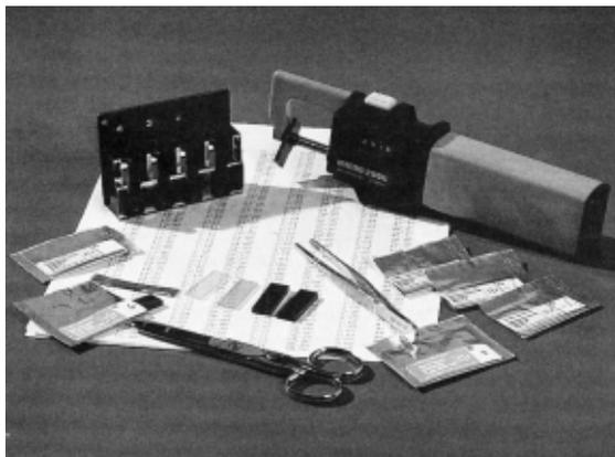
**Figura 10. Dosimetri in polimetilmetacrilato “Red Perspex 4034” e “Gammacrome YR” con le loro bustine di poliaccoppiato in cui sono conservati. Sullo sfondo un portacampioni a quattro scomparti per la lettura allo spettrofotometro dei dosimetri e un calibro per la misura del loro spessore**
