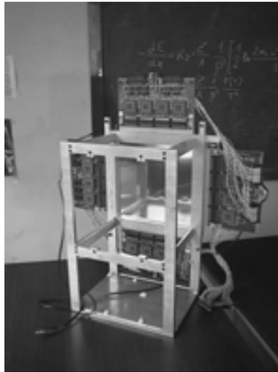
Figura 7. La camera a ionizzazione a *pixel* 24x24 cm<sup>2</sup>, 1024 *pixel*
