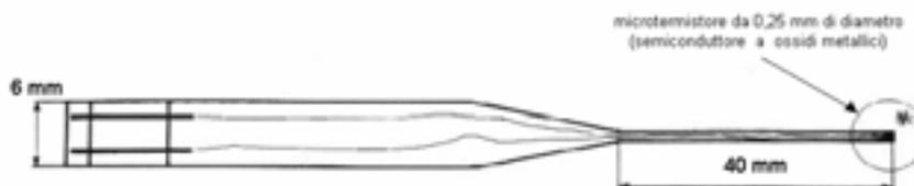
**Figura 3.** Sonda calorimetrica in cui è incluso il microtermistore
